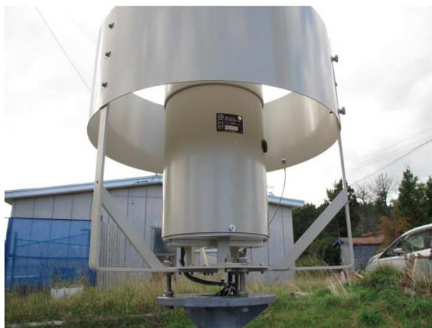
アメダス市浦の「電子制御式ヒータの雨量計」。「温水式雨量計」と比べ、スリムになっています。
