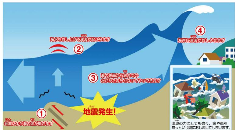
図1 津波の発生の仕組み(気象庁 HP より)
