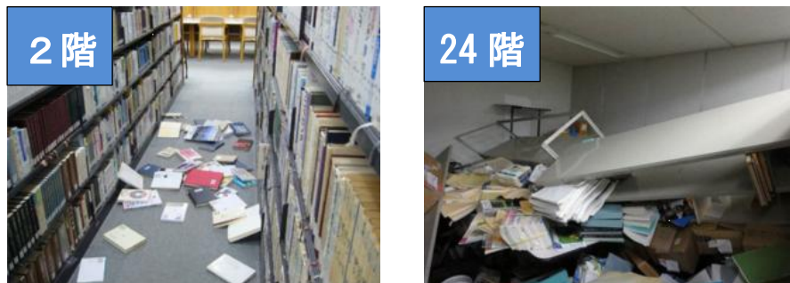
図2 同じビルの高層階と低層階での被害の違い（工学院大学提供）
