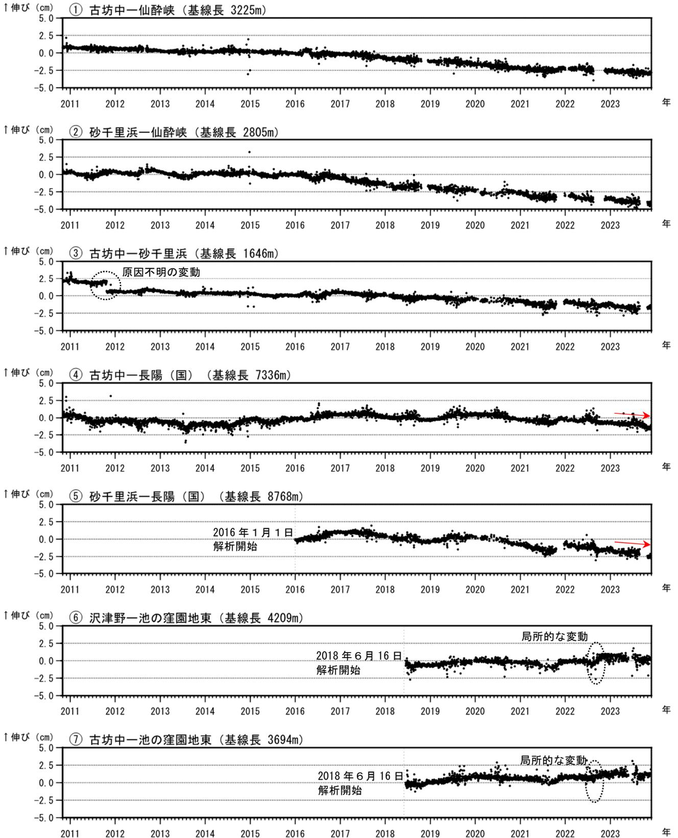
図5 阿蘇山 GNSS 連続観測による基線長変化 (2010年10月～2023年11月)
