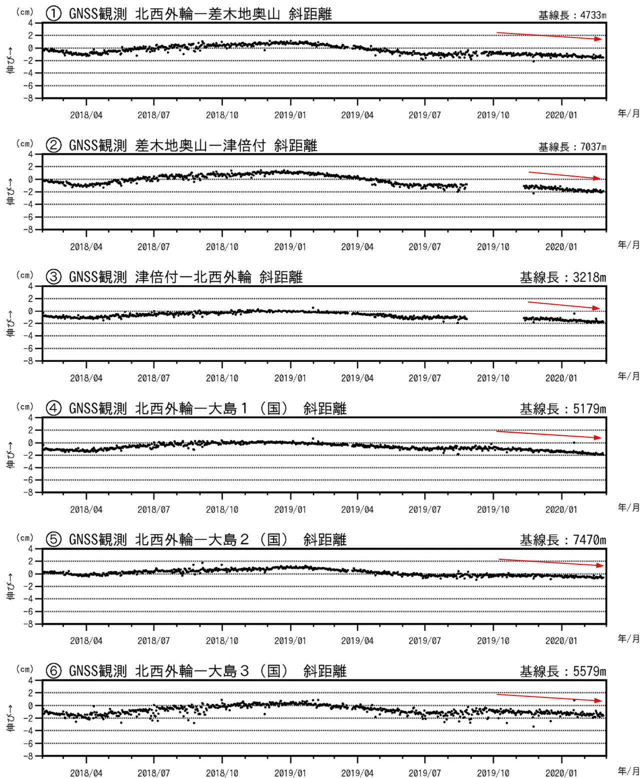
図3-2 伊豆大島 GNSS連続観測による基線長変化(2018年2月~2020年2月29日)
