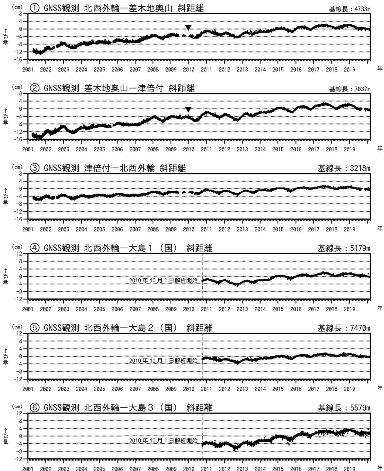
図3-1 伊豆大島 GNSS連続観測による基線長変化(2001年1月~2020年2月29日)
