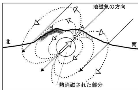
図10 熱消磁に伴う全磁力変化のモデル
