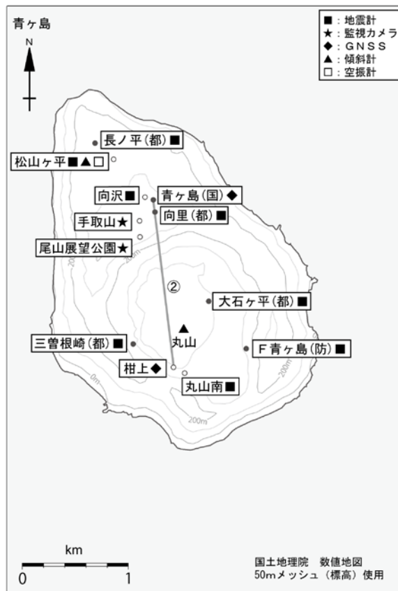
図3 青ヶ島 観測点配置図 GNSS 基線は図2の②に対応しています。
