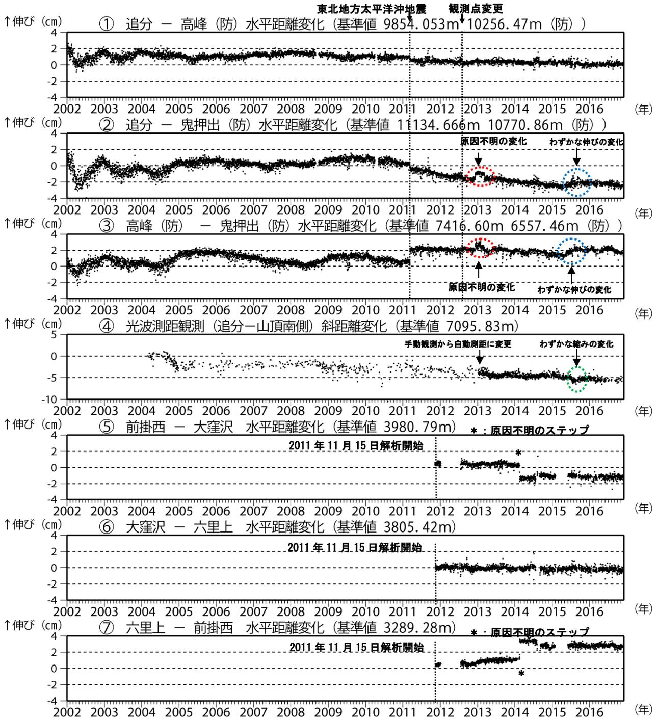
図 5 浅間山 GNSS 連続観測及び光波測距観測の結果(2002 年 1 月 1 日～2016 年 11 月 30 日)
