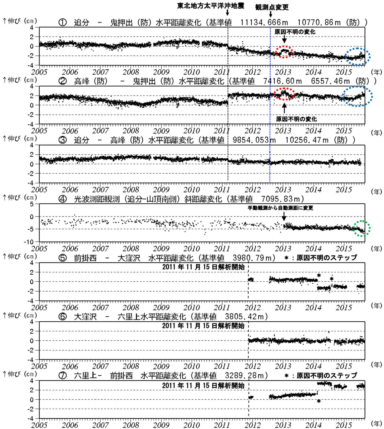
図 8 浅間山 GNSS 連続観測及び光波測距観測の結果 (2005 年 1 月 1 日～2015 年 8 月 31 日)
