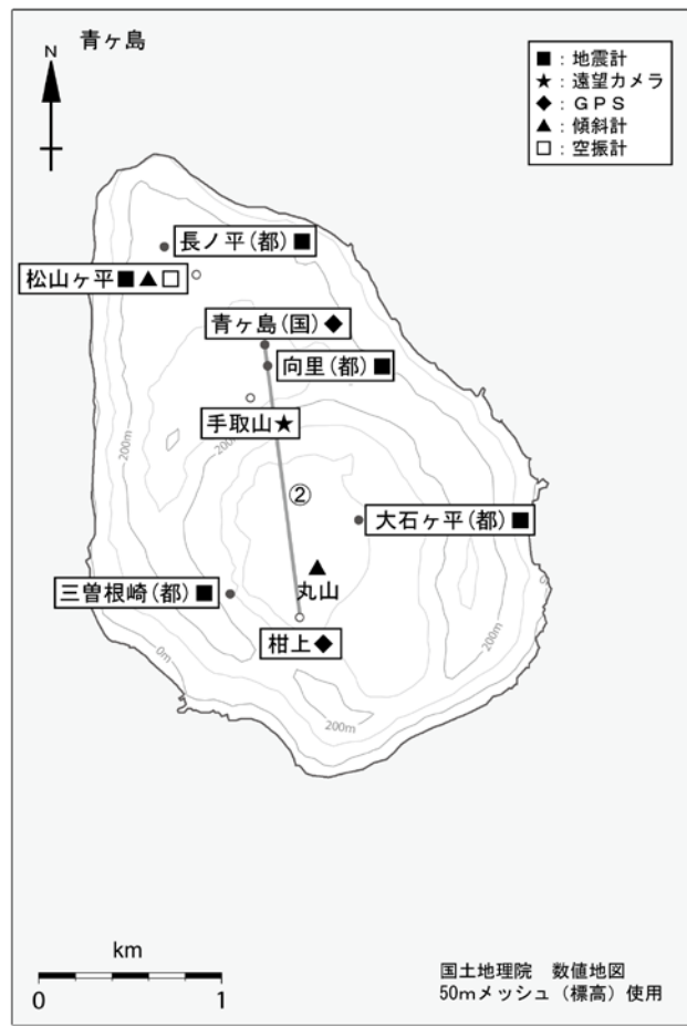
図8 青ヶ島 観測点配置図 GPS基線は図6の②に対応しています。
