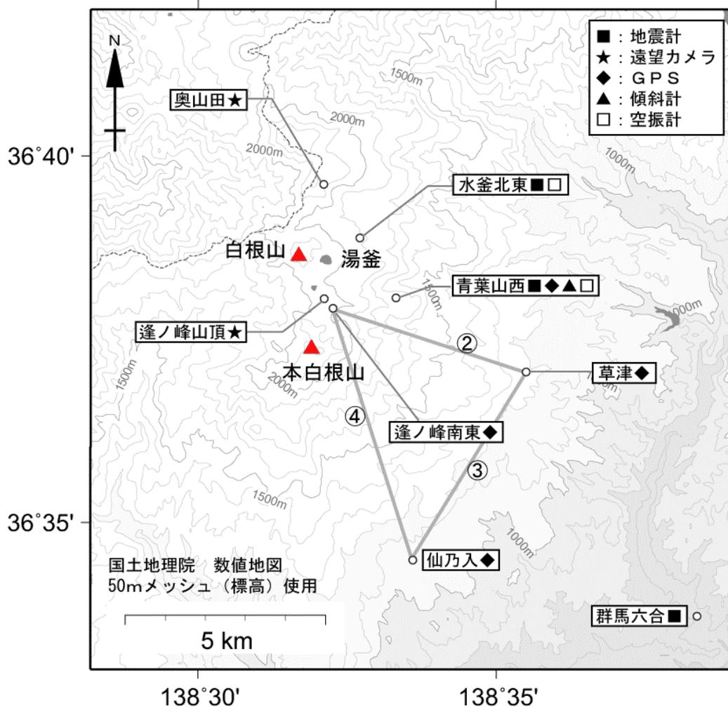
図6 草津白根山 気象庁の観測点配置図（小さな白丸は観測点位置を示しています）
