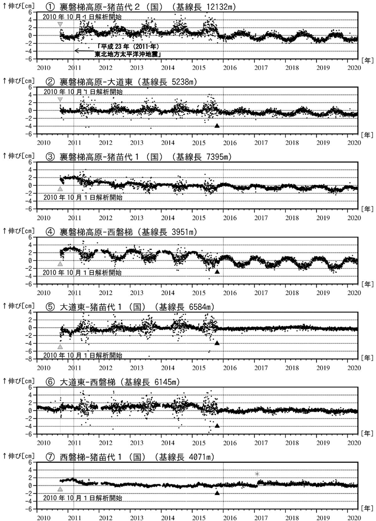
図4 磐梯山 GNSS 基線長変化図 (2010年1月～2020年4月)
