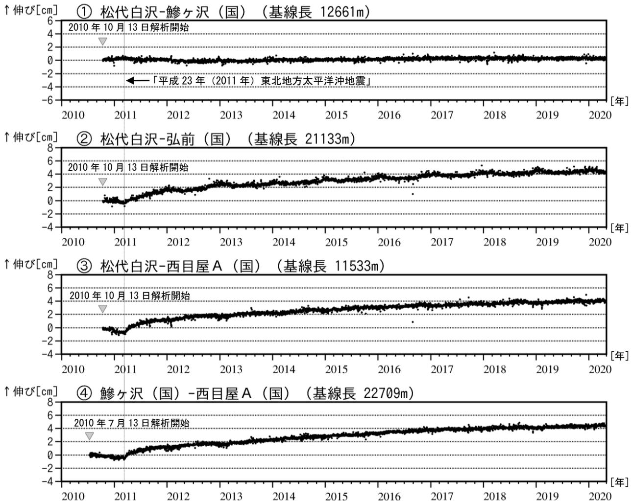
図3 岩木山 GNSS 基線長変化図（2010年7月～2020年4月）
