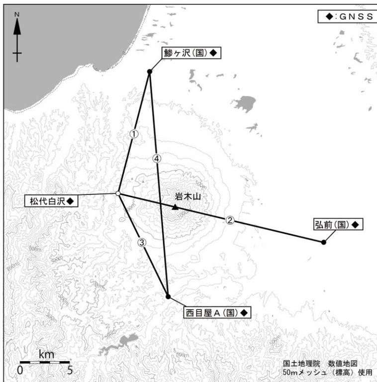
図5 岩木山 GNSS 観測基線図
