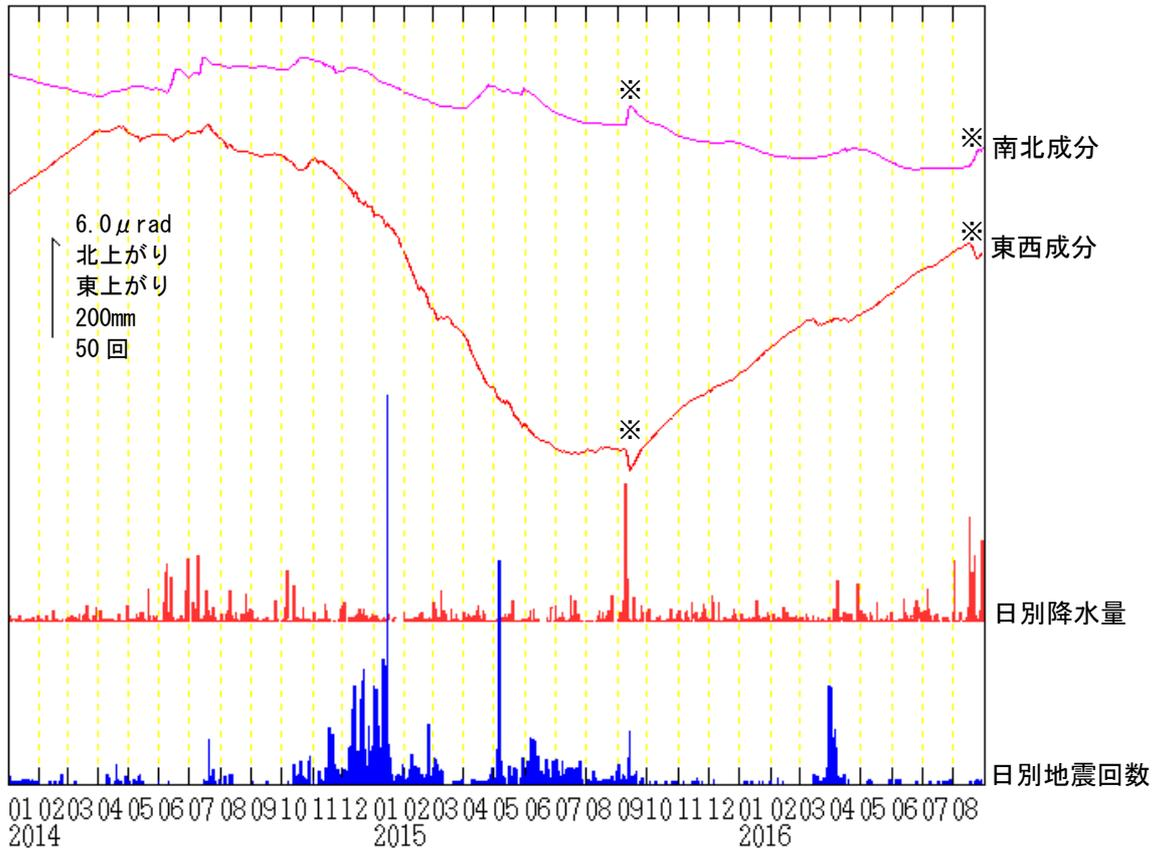
**図 5 吾妻山 浄土平観測点での傾斜変動（2014 年 1 月～2016 年 8 月、時間値、潮汐補正あり）**
