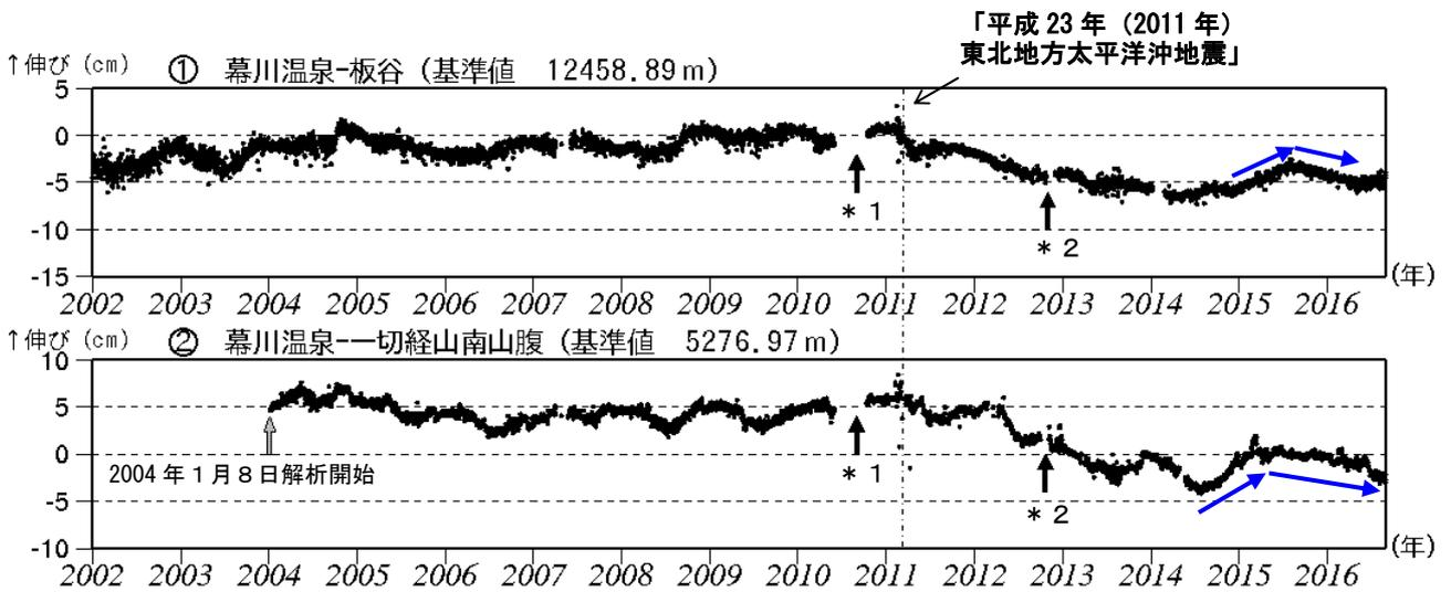
図7-1 吾妻山 GNSS 基線長変化図 (2002 年 1 月~2016 年 8 月)
