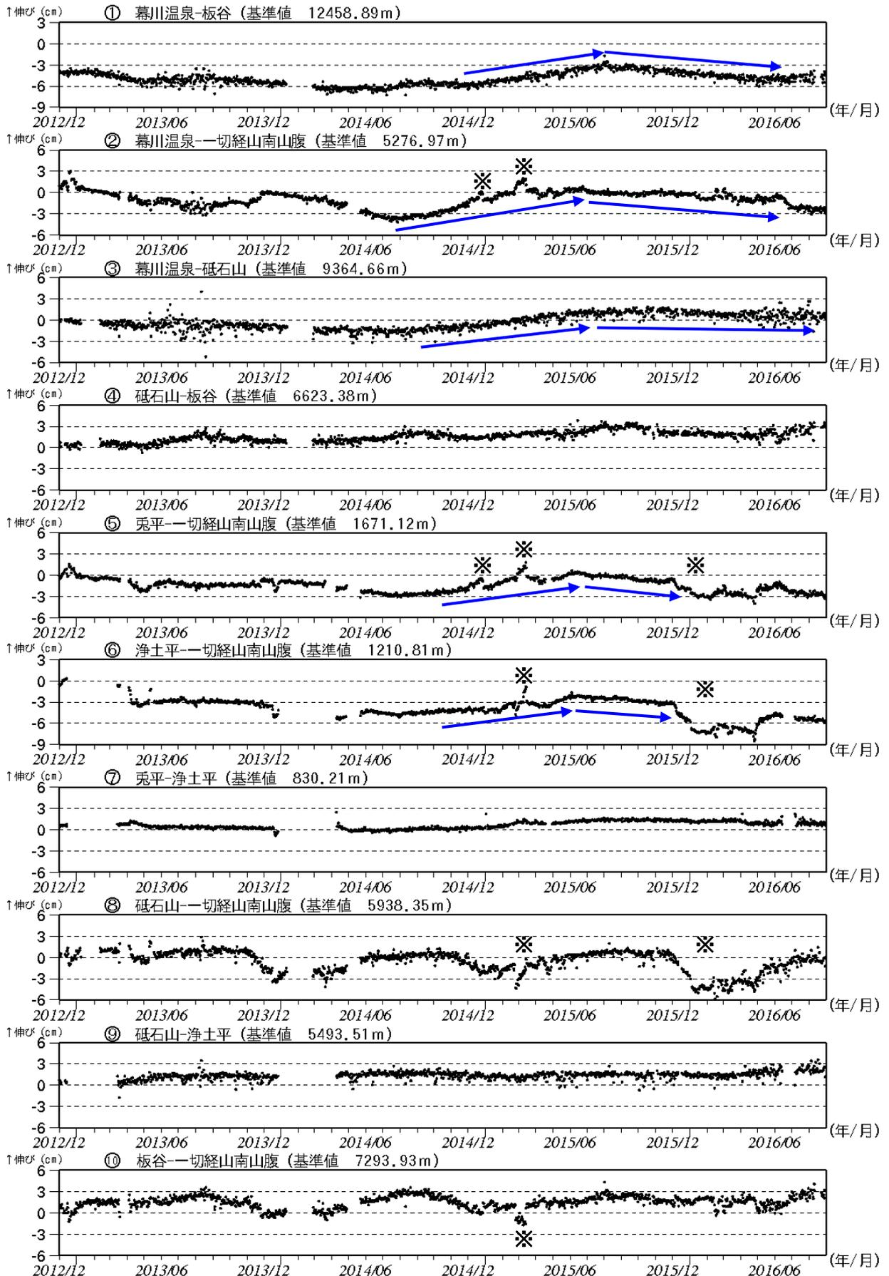
図 7-2 吾妻山 GNSS 基線長変化図 (2012 年 12 月～2016 年 8 月)
