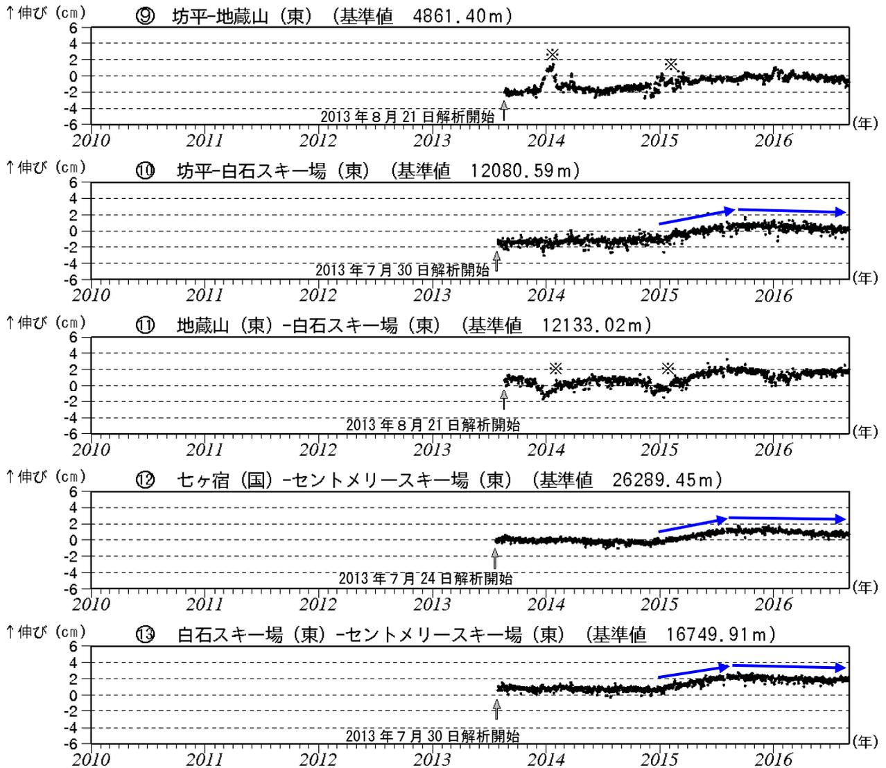
図 11-2 蔵王山 GNSS 基線長変化図 (2010 年 10 月～2016 年 8 月)
