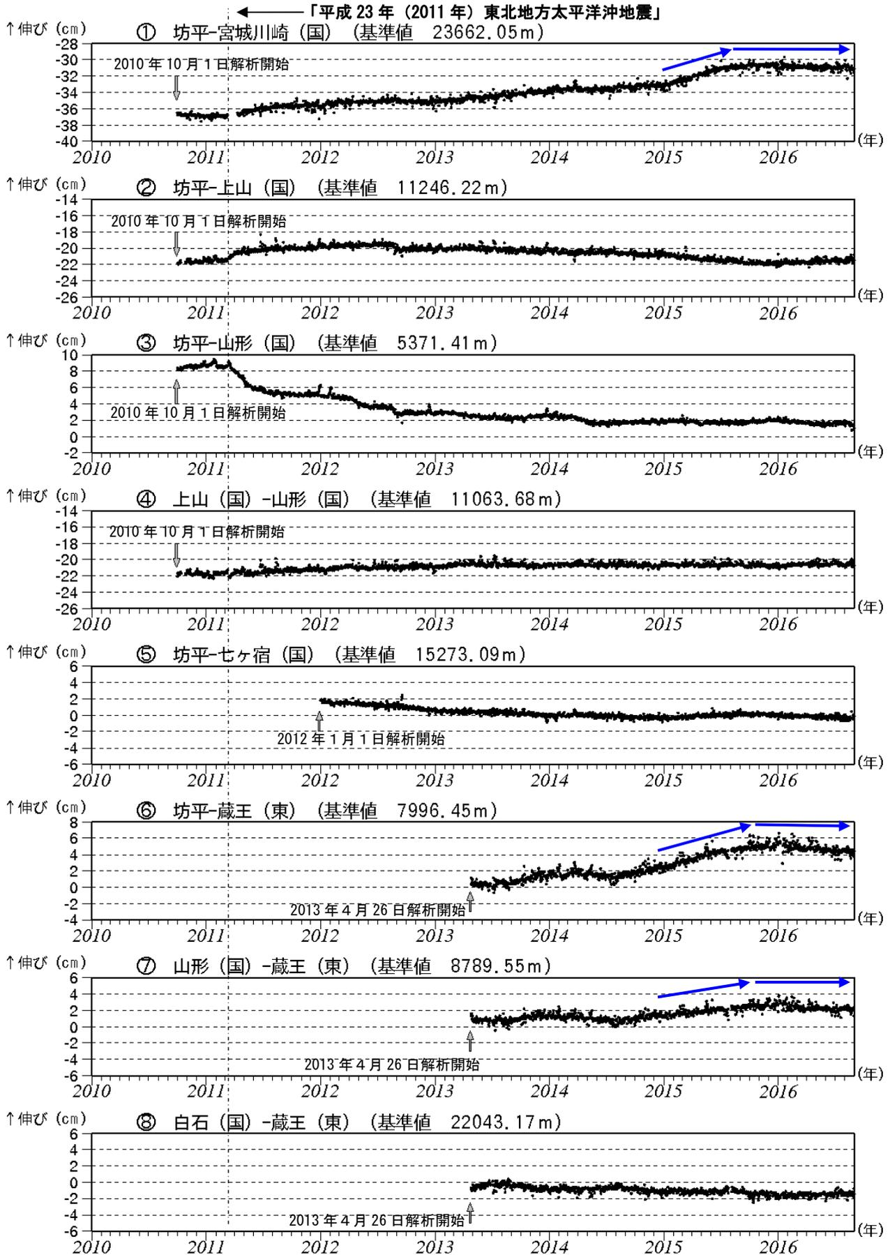
図 11-1 蔵王山 GNSS 基線長変化図 (2010 年 10 月～2016 年 8 月)
