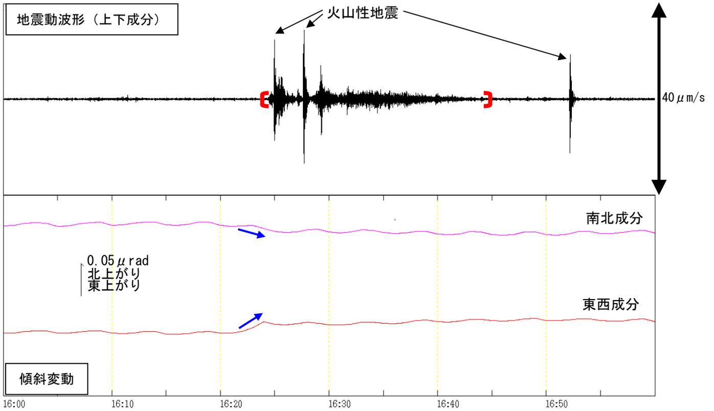
図 10 蔵王山 坊平観測点での火山性微動波形および傾斜変動
