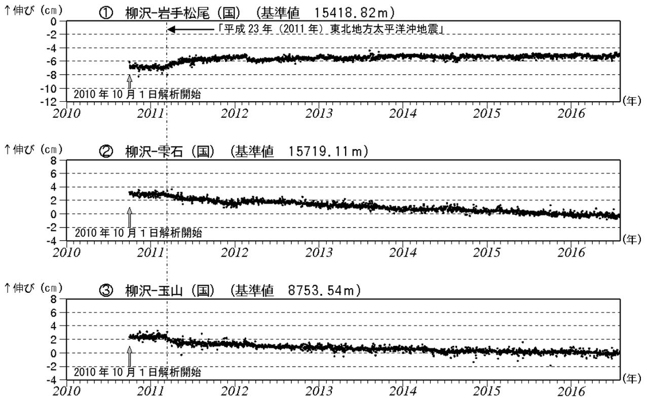
図3 岩手山 GNSS<sup>1)</sup> 基線長変化図 (2010年10月～2016年7月)
