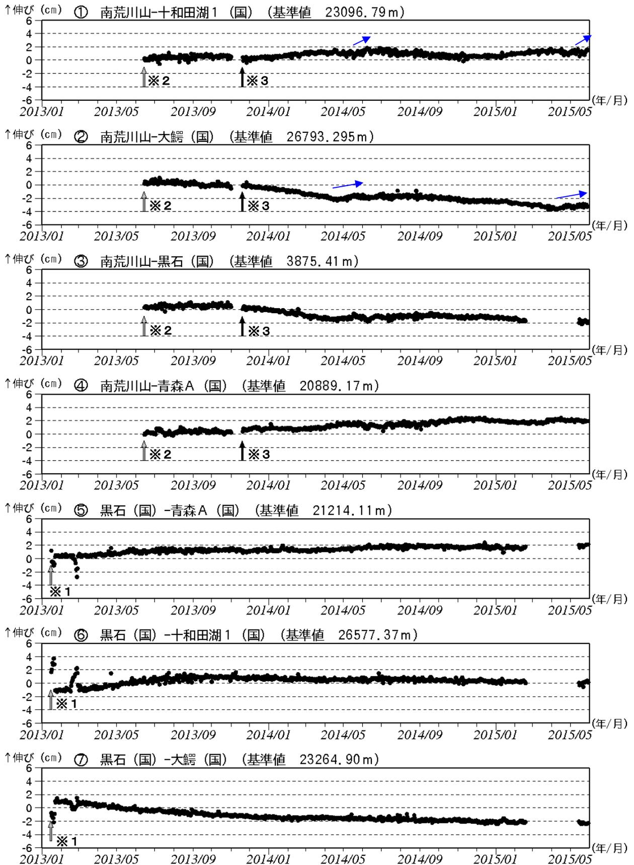
図 3-① 八甲田山 GNSS 基線長変化図 (2013 年 1 月～2015 年 5 月)
