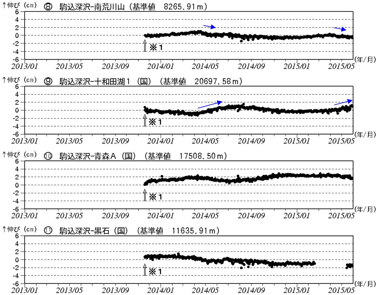
図3-② 八甲田山 GNSS 基線長変化図 (2013年1月～2015年5月)
