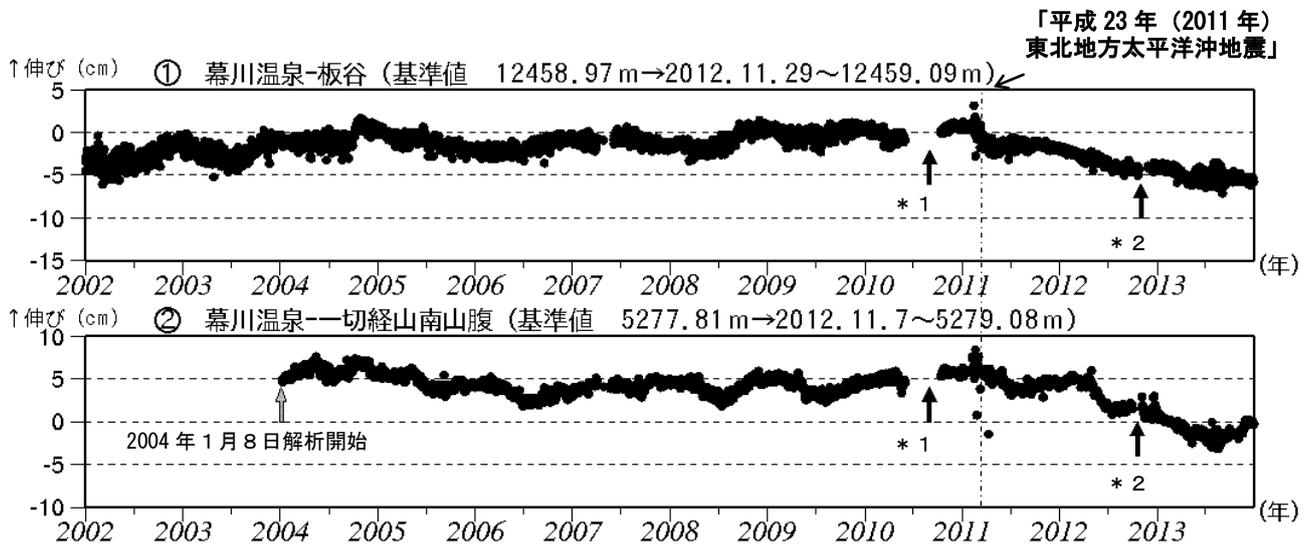
図4 吾妻山 GPS 基線長変化図 (2002 年 1 月～2013 年 12 月)
