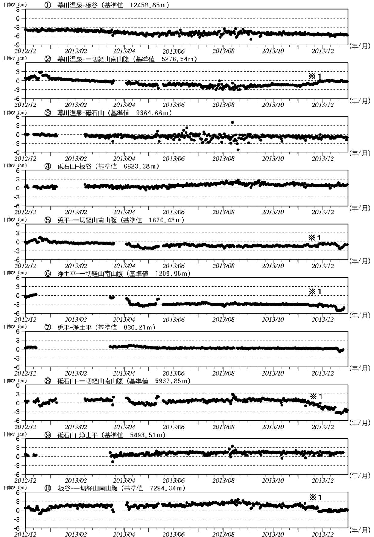
図5 吾妻山 GPS 基線長変化図 (2012 年 12 月～2013 年 12 月)
