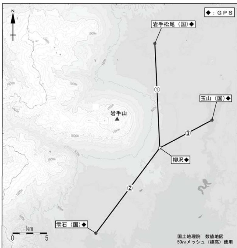
図8 岩手山 GPS観測点配置図
