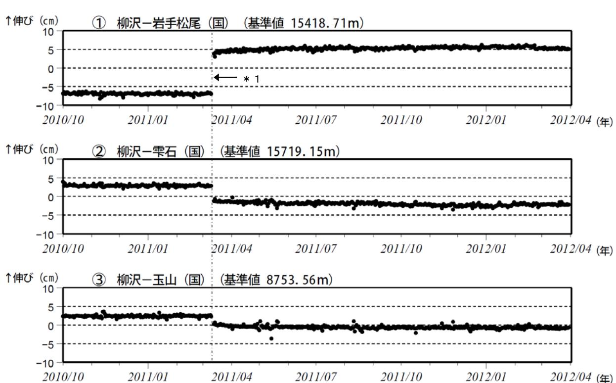
図9\* 岩手山 GPS基線長変化図（2010年10月～2012年3月）
