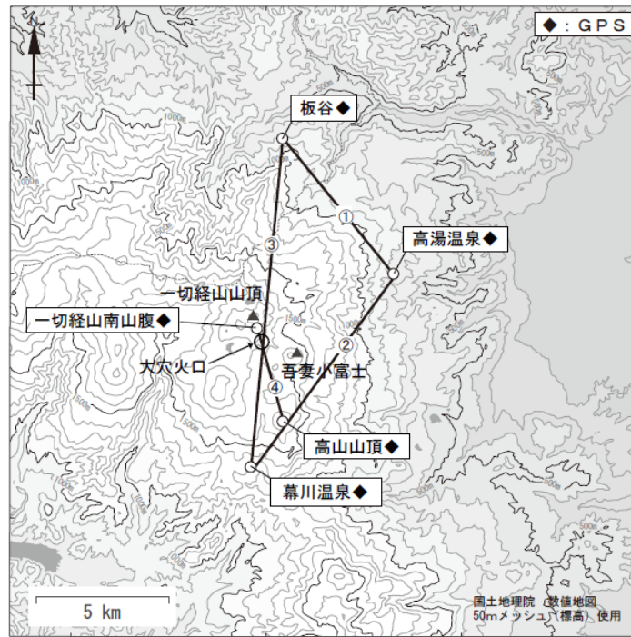
図9 吾妻山 GPS 観測点配置図 GPS 基線①～④は図10の①～④に対応しています。
