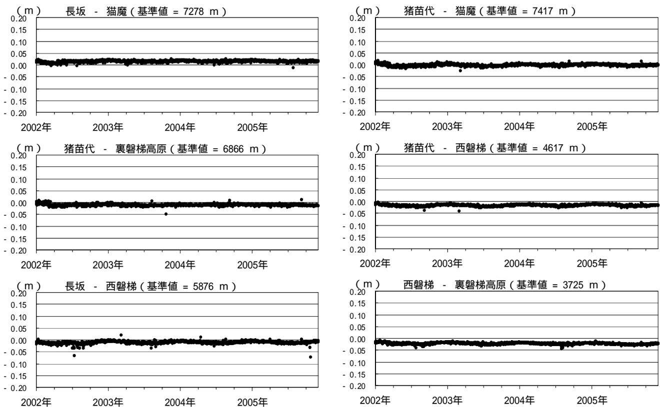
図6 GPS 基線長変化図（2002年1月～2005年11月）
