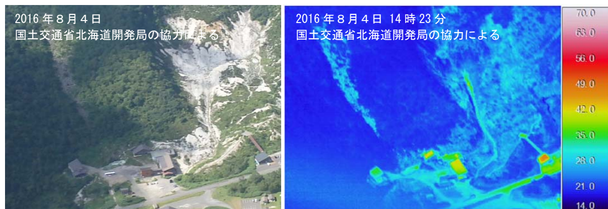
図 3 ニセコ 赤外熱映像装置による五色温泉周辺の地表面温度分布 図 1 中の②から撮影
