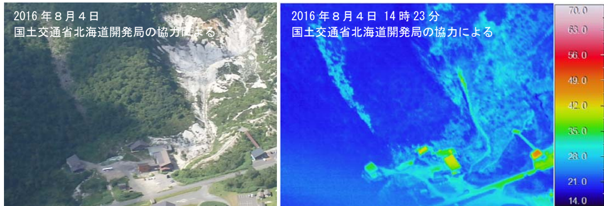
図 3 ニセコ 赤外熱映像装置による五色温泉周辺の地表面温度分布 図 1－②から撮影
