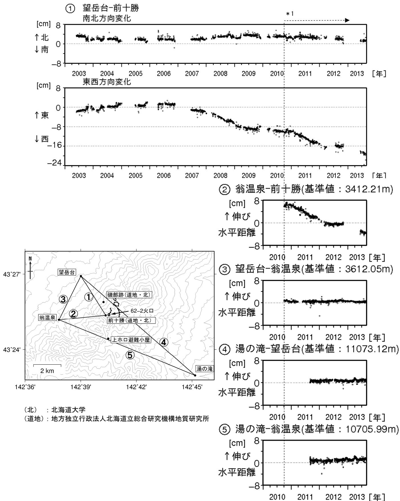
図 4 十勝岳 GPS連続観測による基線長変化(2003年5月~2013年8月)及び観測点配置図
