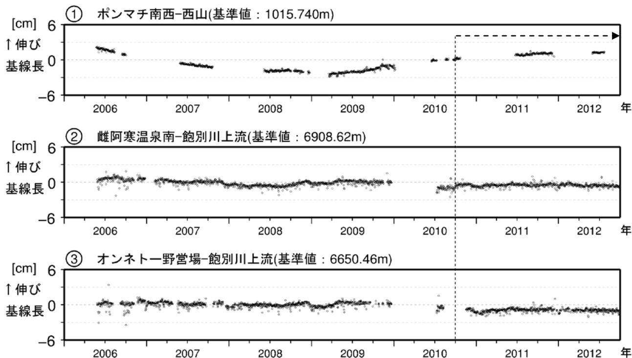
図5 雌阿寒岳 GPS連続観測による基線長変化 (2006年1月~2012年9月)
