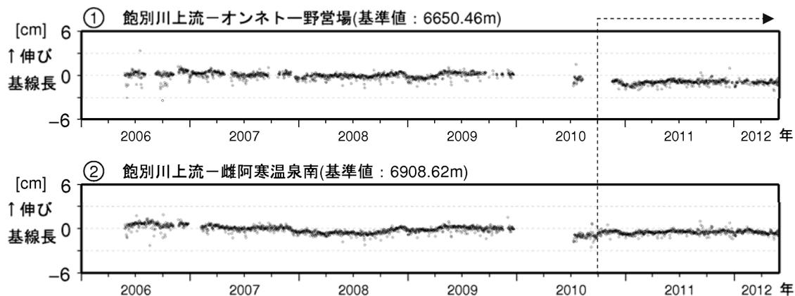
図 5 雌阿寒岳 GPS連続観測による基線長変化 (2006年 1 月~2012年 5 月)
