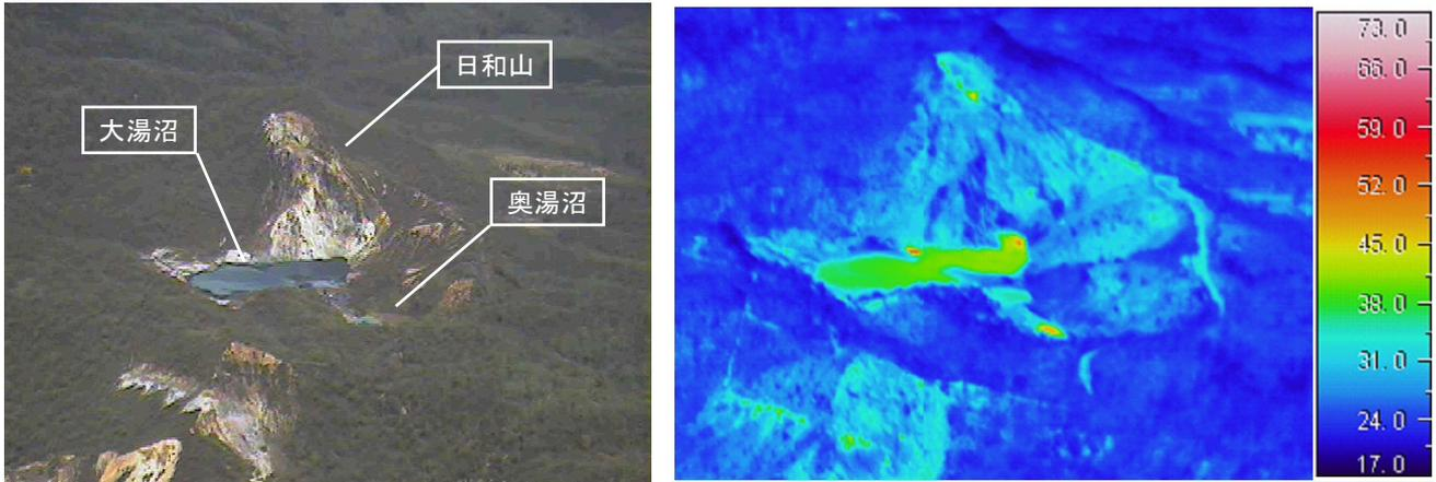
図 3 倶多楽 赤外熱映像装置\*による日和山および大湯沼周辺の表面温度分布
