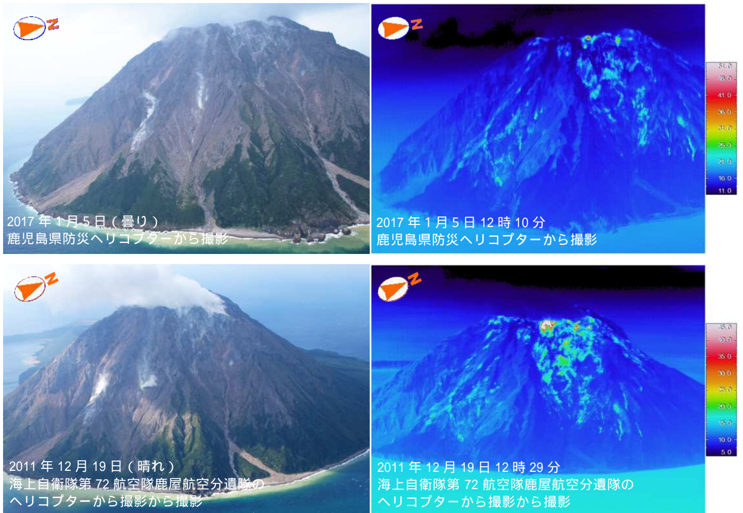
図 3 薩摩硫黄島 硫黄岳の地表面温度分布 (上 : 2017 年 1 月 5 日、下 : 2011 年 12 月 19 日) 火口周辺及び山腹で熱異常域を観測しましたが、前回 (2011 年 12 月 19 日) と比較して、熱異常域の拡大や高まりは認められませんでした。
