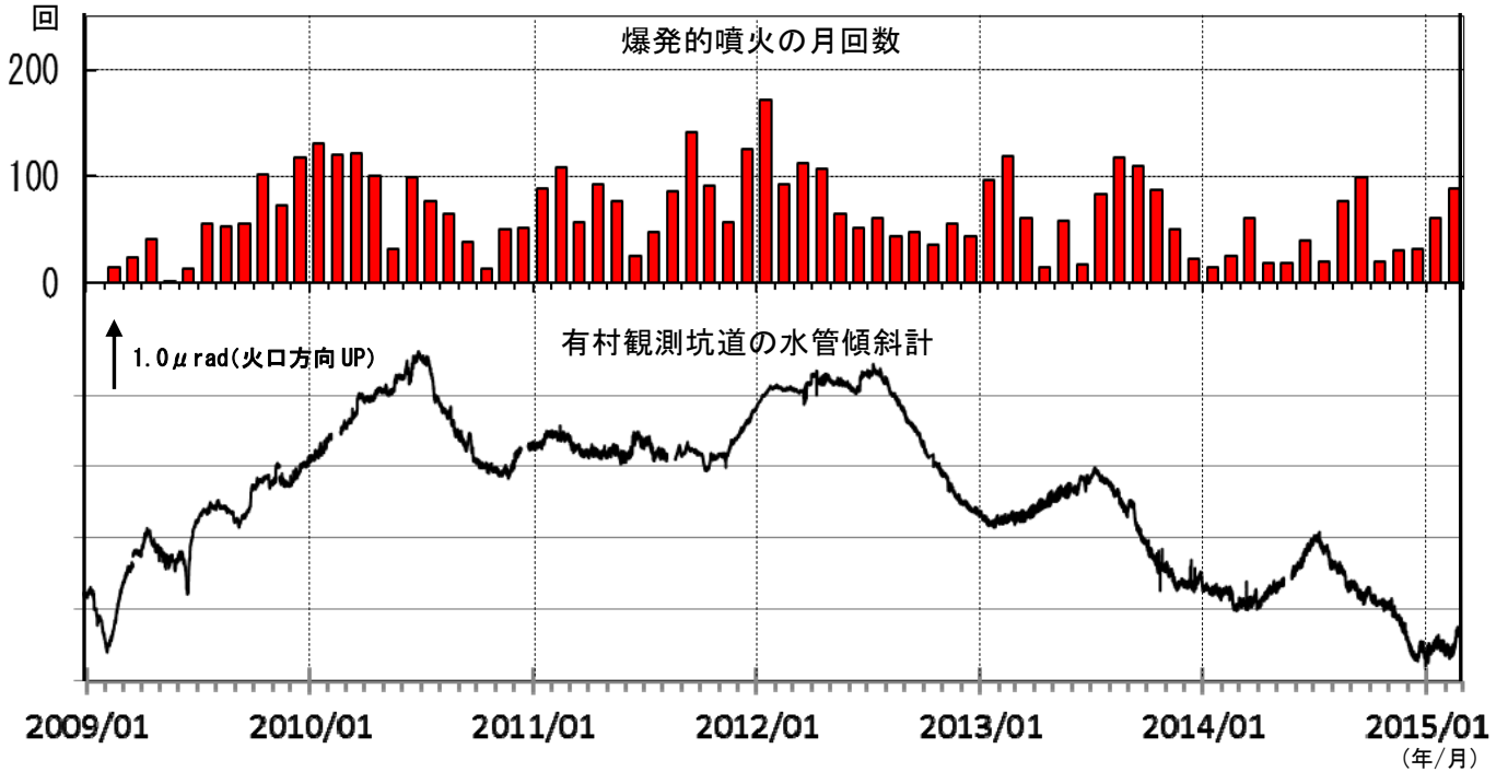
図9 桜島 島内傾斜計の変化（2009年1月～2015年2月） （下図：有村観測坑道の水管傾斜計（大隅河川国道事務所設置））
