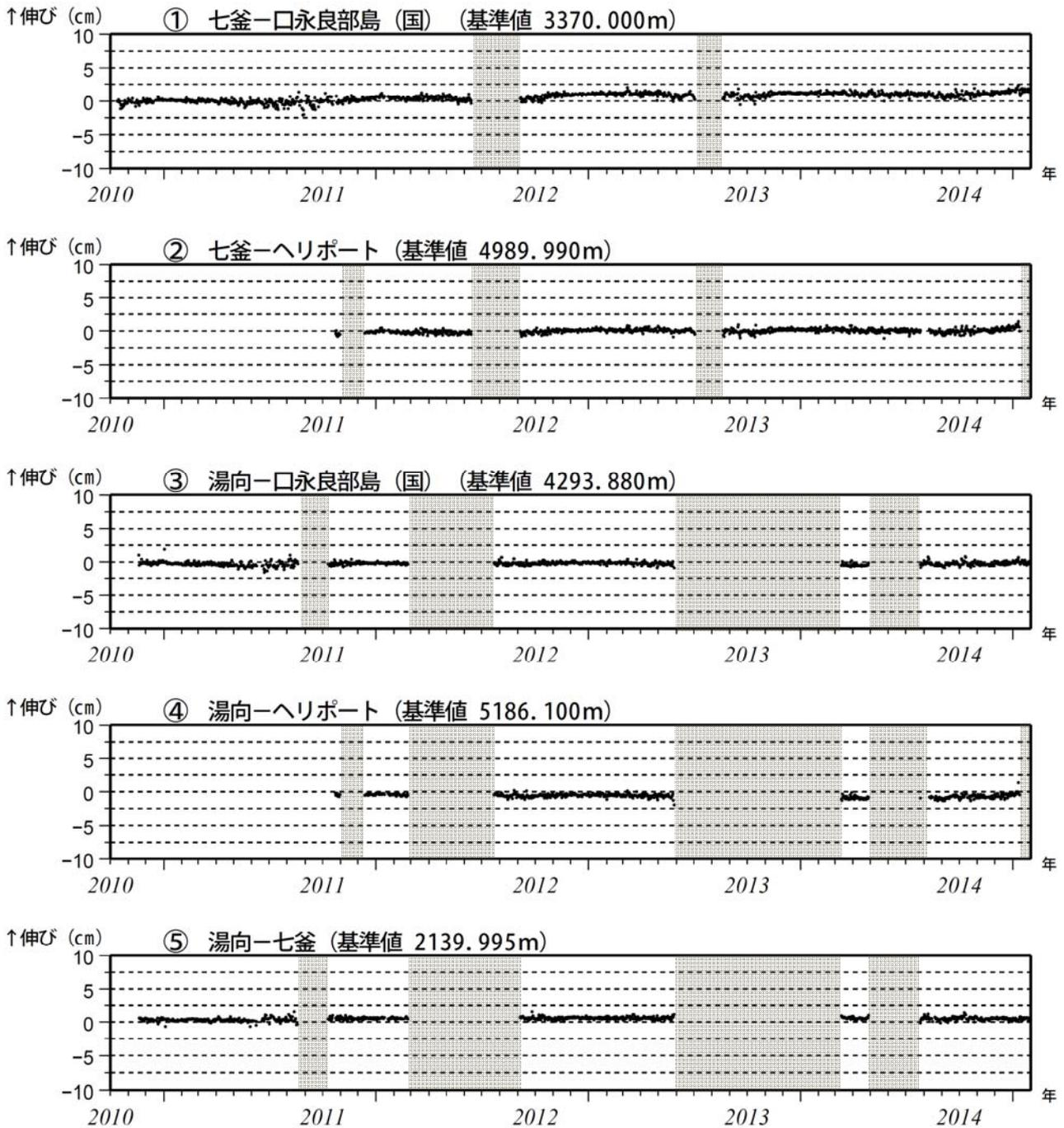
図3 口永良部島 GNSS 連続観測による基線長変化（2010年10月～2015年1月）
