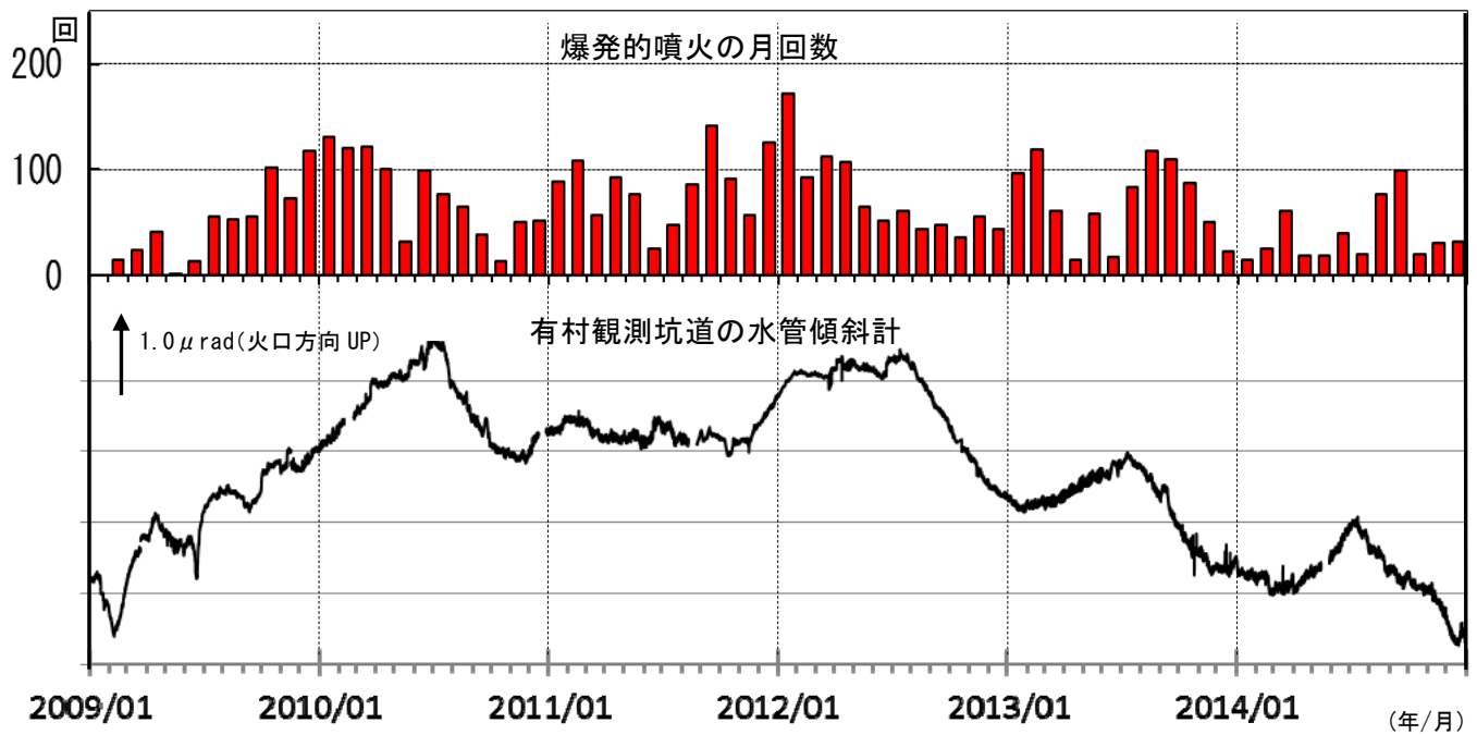
図9 桜島 島内傾斜計の変化（2009年1月～2014年12月） （下図：有村観測坑道の水管傾斜計（大隅河川国道事務所設置））
