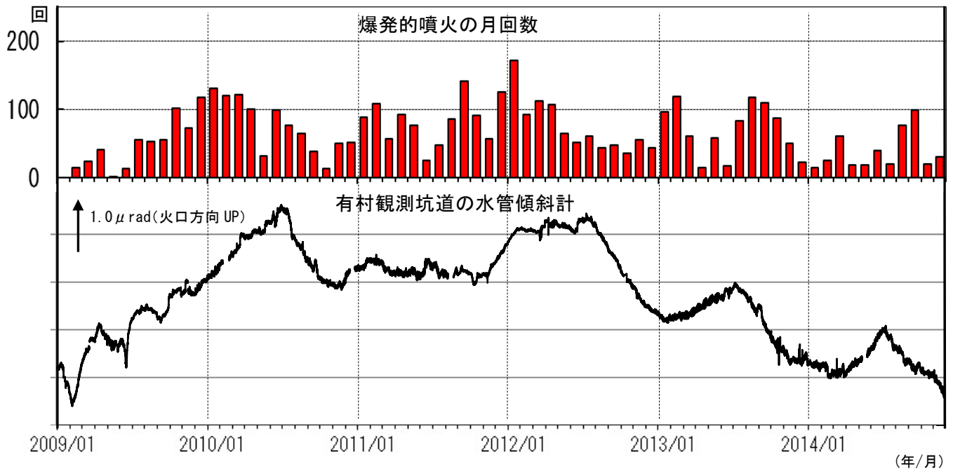
図 10 桜島 島内傾斜計の変化（2009 年 1 月～2014 年 11 月） （下図：有村観測坑道の水管傾斜計（大隅河川国道事務所設置））
