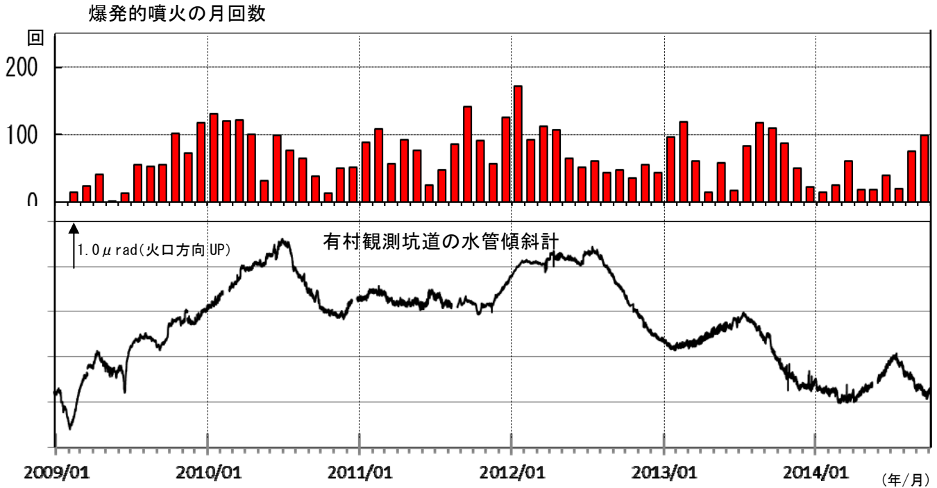
図 8 桜島 島内傾斜計の変化（2009 年 1 月～2014 年 9 月） （下図：有村観測坑道の水管傾斜計（大隅河川国道事務所設置））
