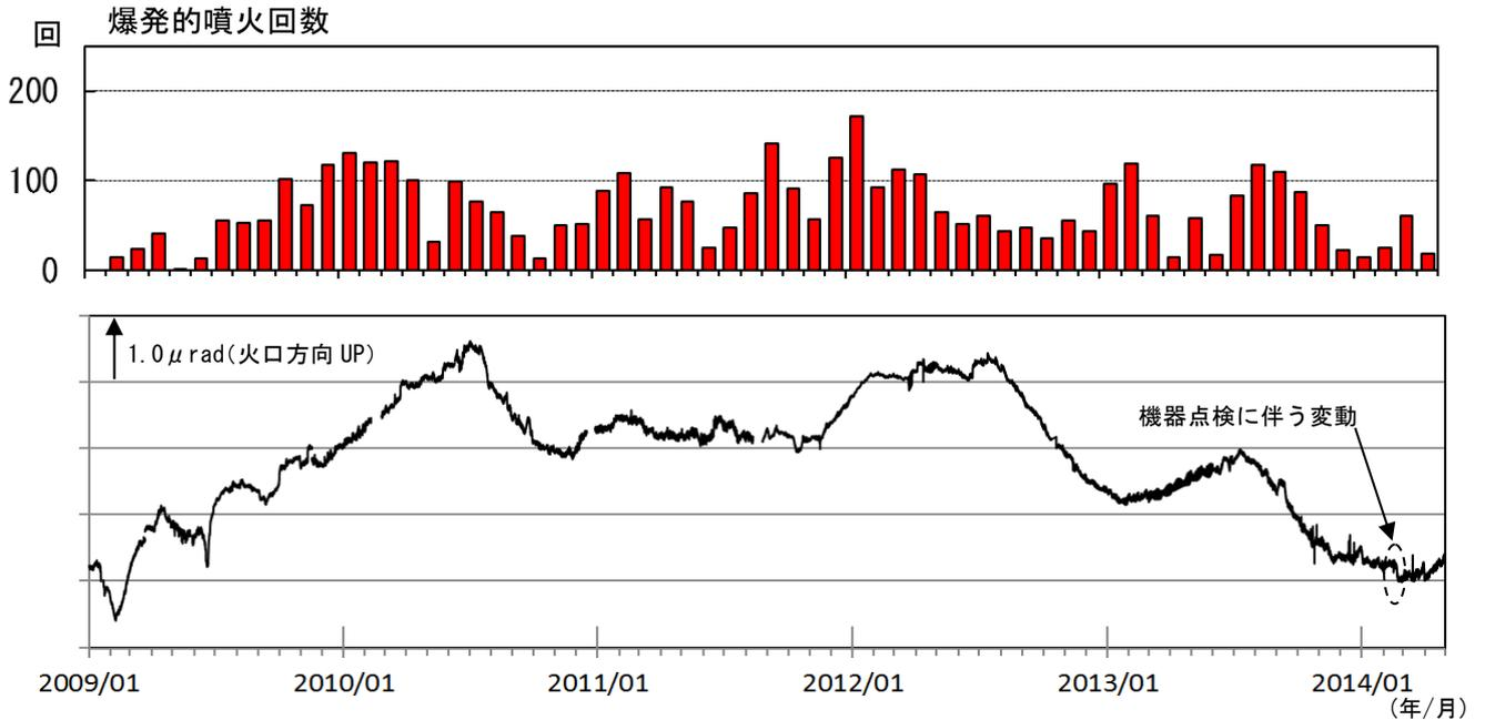
図5 桜島 有村観測坑道の水管傾斜計（大隅河川国道事務所設置）の変化（2009年1月～2014年4月）
