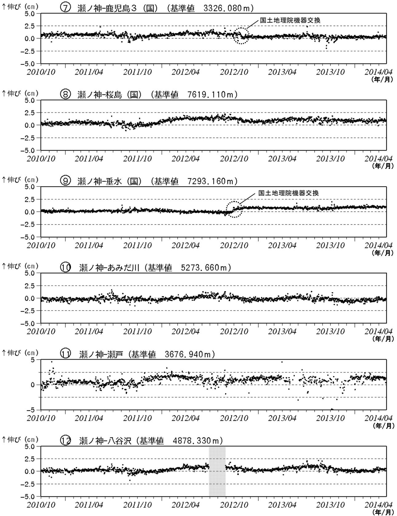
図 8-2 桜島 GNSS 連続観測による基線長変化 (2010 年 10 月~2014 年 4 月)
