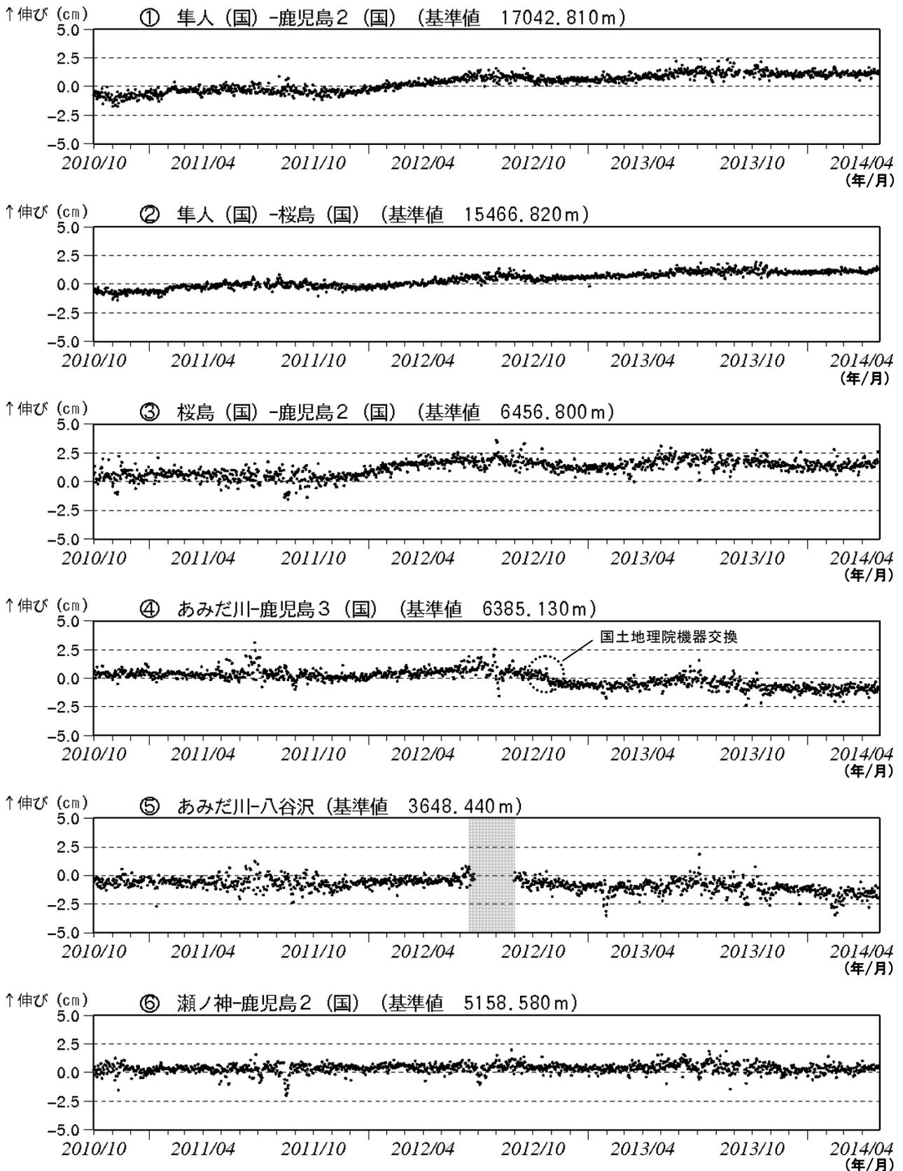
図 8-1 桜島 GNSS 連続観測による基線長変化（2010 年 10 月～2014 年 4 月）
