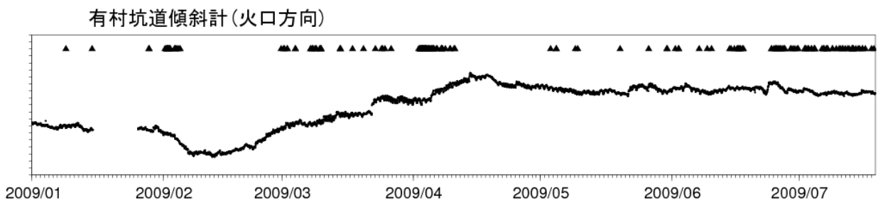
図 4 桜島 有村観測坑道の水管傾斜計 (大隅河川国道事務所設置) の変化 (2009 年 1 月 ~ 7 月)
