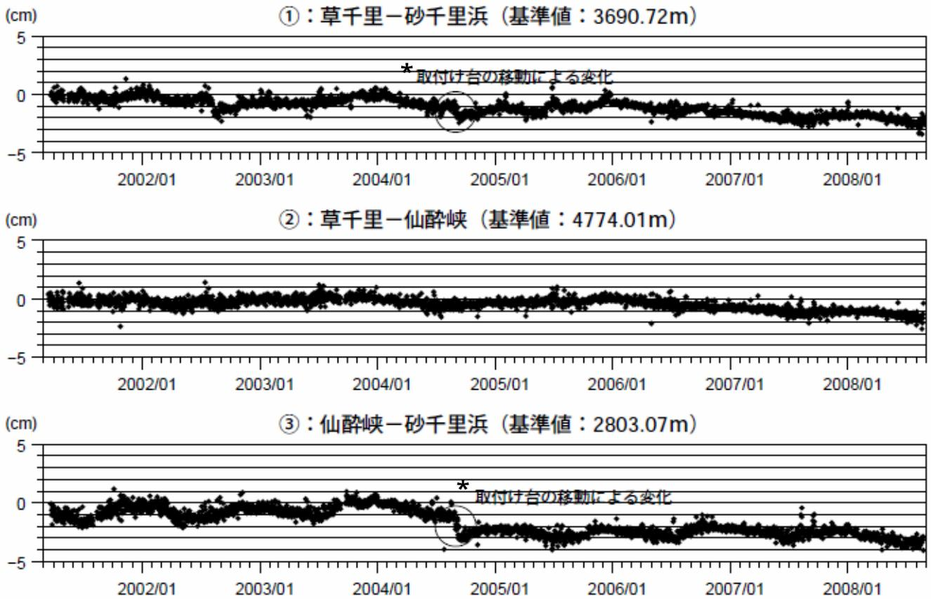
図5 阿蘇山 GPS 連続観測による基線長変化(2001年3月15日～2008年8月31日)
