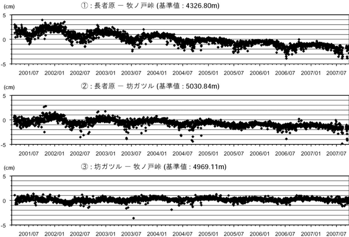
図4 九重山 GPS連続観測による基線長変化(2001年3月1日~2007年9月30日)
