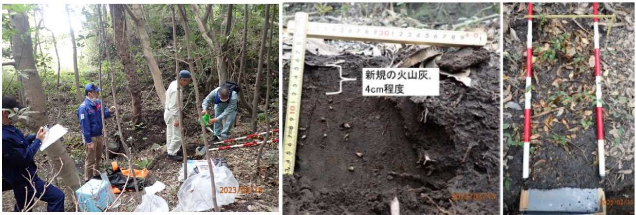
図 4 地上での浸透能調査の様子 (2023 年 3 月 15 日実施)
