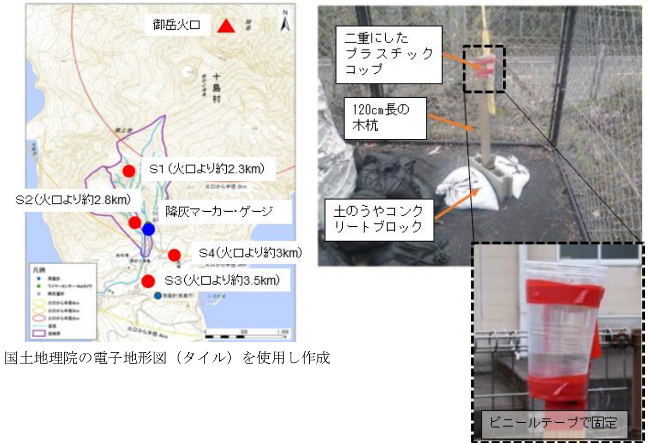
図 2 簡易降灰量計及び降灰ゲージ・降灰マーカージェージ設置位置図および写真
