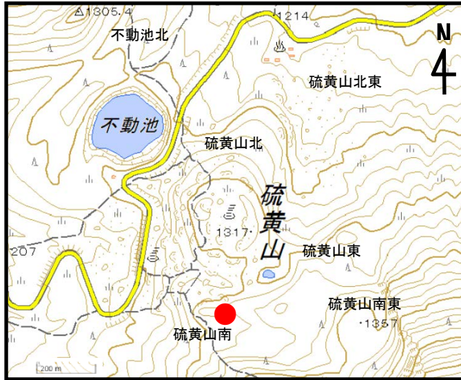
第13-1図 霧島山（えびの高原（硫黄山）周辺） 全磁力連続観測点配置図
