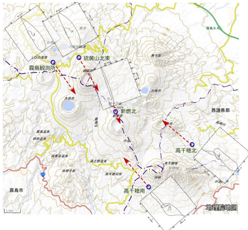
第24図 霧島山（新燃岳） 2017年10月14日12時30分のBL型地震に伴った長周期震動 ・卓越周期は約12秒で、震動軌跡は、概ね新燃岳付近を指し示す。 Fig. 24. Long-period ground Motion accompanied by BL type earthquake at 12:30 on October 14, 2017.
