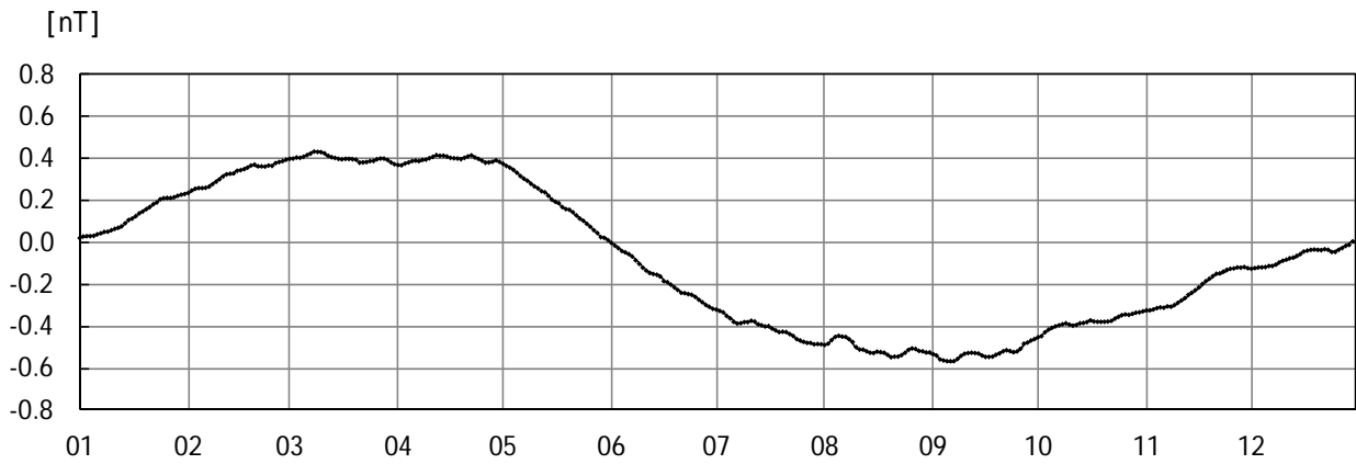
第 6 図 MEAとMMBの全磁力日平均値差の年周変化( 2005 ~ 2007, 2011年の 1 ~ 12月のデータから求めた30日移動平均値 )
