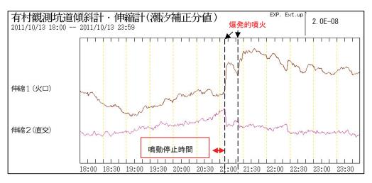
第 21 図<sup>\*</sup> 桜島 21 時 07 分の爆発的噴火時の有村坑道の伸縮計データ(2011 年 10 月 13 日 18~24 時) Fig.21 Crustal movement observed by Arimura underground tunnel extensometer
