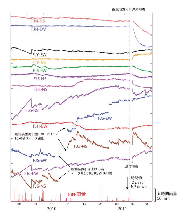
第4図 防災科学技術研究所・富士山火山活動観測網による傾斜変動観測結果。表示期間は2010年8月1 日~2011年4月20日で,表示データは時値(毎正時の値)。図中破線は東北地方太平洋沖地震の 発生日を示す。
