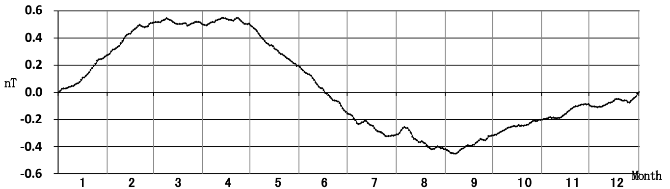
第3図 MEAとMMBの全磁力日平均値差の年周変化 (2005年1月～2007年12月のデータから求めた30日移動平均値)。
