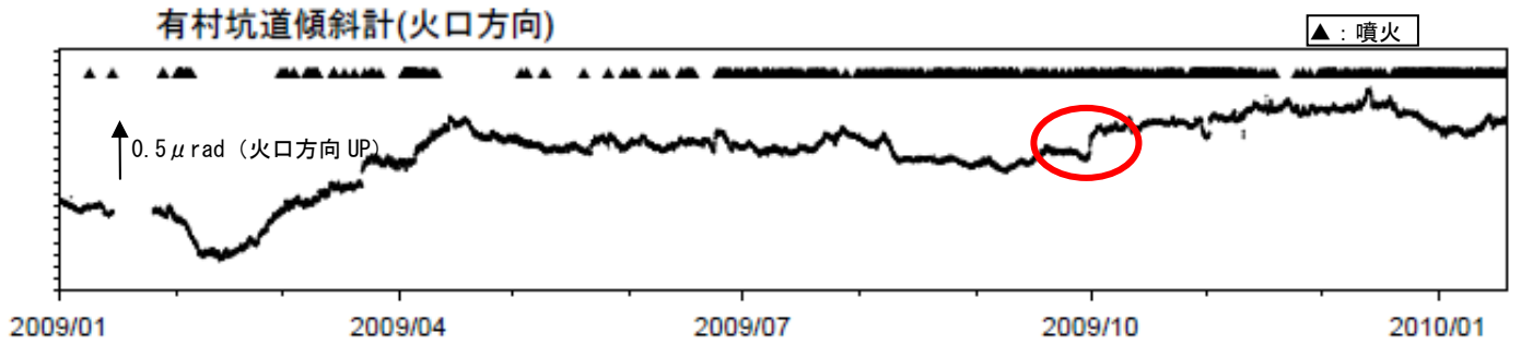
第10図※ 桜島 有村水管傾斜計火口方向の傾斜変動(2009年1月1日～2010年1月18日) Fig.10 Crustal movement observed at Arimura underground tunnel tiltmeter(January 1,2009 – January 18, 2010).
