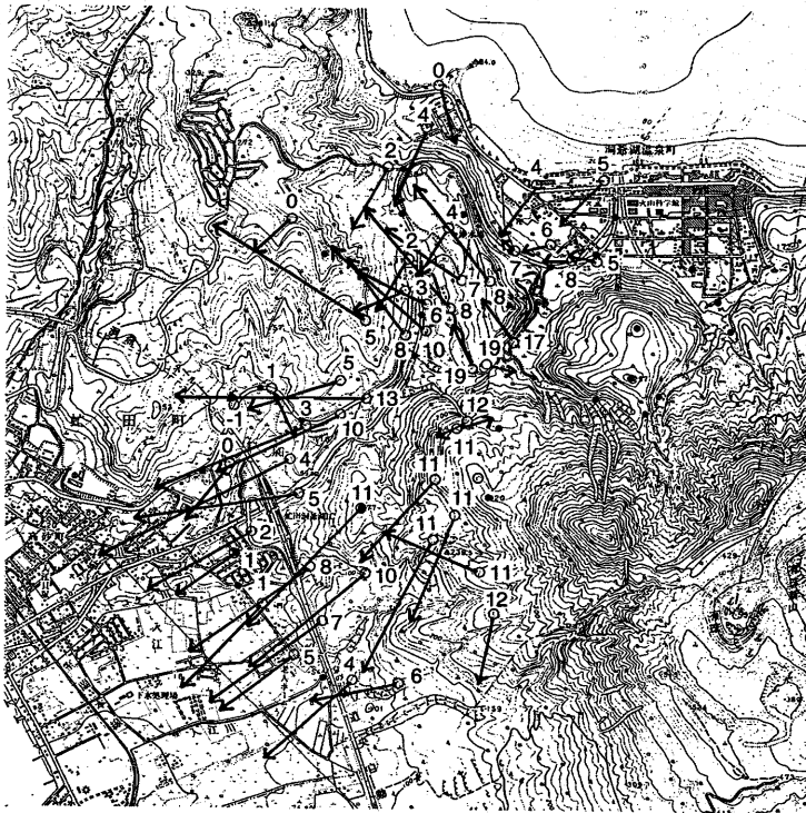
第1図 1993年8月22日-2000年4月3日間の変動 数字は垂直方向の変動量 (m)。 Fig.1 Deformation on the west flank of Usu volcano, between August 22, 1993 and April 3, 2000. Each number shows the vertical movement in meter.
