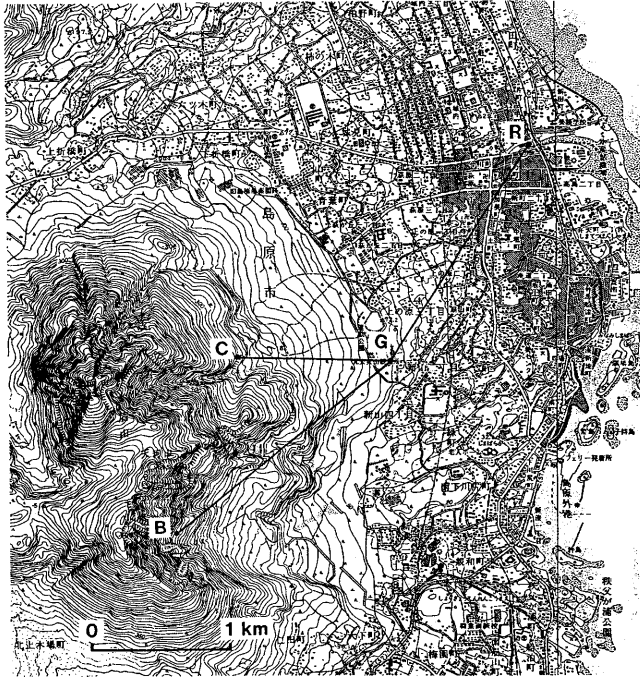
第1図 眉山東斜面の光波測距観測網 Fig. 1 EDM network around Mayu-yama.
