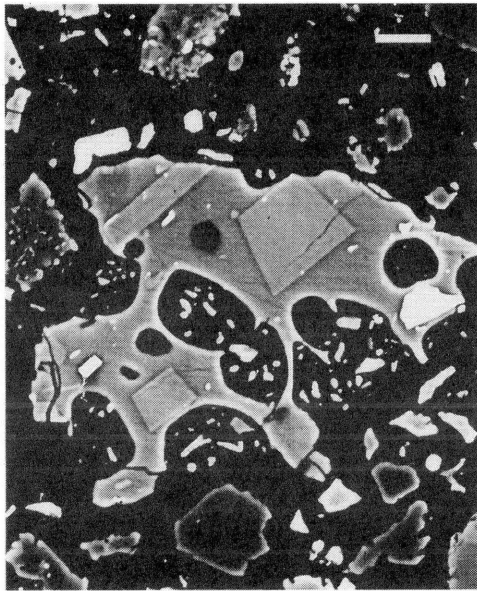
第 2 図 火山灰中ガラスの組成像。上 2 つが10月13日採取の未発泡ガラス。下 2 つが12月22日採取の発泡ガラス。ガラス（灰色）の中や縁にある明るい色や灰色の多角形は結晶。両者で結晶量が明らかに違う。下図の丸い形は泡の外形。各写真右上角の白バーが10ミクロン長。撮影者：本村慶信。 Fig. 2 EPMA compositional images of clear glass particles. Upper two photos for 13 October 1995 sample, and lower two photos for vesiculated, crystal-rich samples on 22 December 1995 (photo by Y. Motomura)
