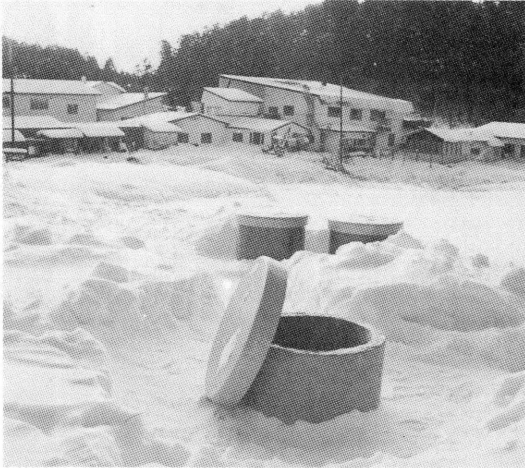
第 2 図 噴火予知計画に基づく北海道大学理学部の雌阿寒岳の火山観測研究施設（平成 4 年 2 月竣工）。右図；雌阿寒岳野中温泉送信所（空振計，テレメータ機器設置，左手前前），左図；地震観測井（38 m 深，1 Hz 3 成分地震計，手前のマンホール），及び地表加速度計，傾斜計，増幅器類（奥のマンホール）。右図奥のアンテナ付きの小屋は，北海道開発局の雨量テレメータ。
